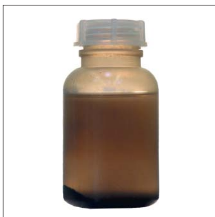
Fot. 1 Woda pobrana z instalacji c.o. prywatnego domu mieszkalnego
