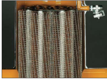
Przekrój separatora – wewnątrz wypełnione rurami spiro, które separują mikropęcherze
