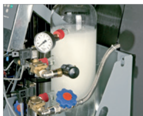
Część wody instalacyjnej zostaje poddana podciśnieniu.
