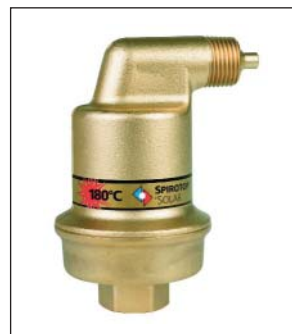
Odpowietrzniki z brązu, stali nierdzewnej, do instalacji i systemów solarnych, na wysoką temperaturę do 180°C i ciśnienie do 25 bar
